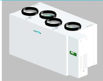
EuroAir Lüftungsgeräte haben einen Aluminium Kreuz-Gegenstrom-Wärmetauscher mit einem therm. Wirkungsgrad von >95%. Durch den hochwertigen Wärmetauscher und die digitale Regelung ist die Ventilation auch bei einer Außentemperatur von -20°C ohne Nacherwärmung gewährleistet. EuroAir Lüftungsgeräte sind lieferbar in 180 – 250 – 400 m<sup>3</sup>/h Luftvolumenstrom.
