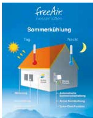
freeAir 100 verfügt über eine patentrechtlich geschützte, automat. Sommer-/Winterrumschaltung. Unterschreitet die Außentemperatur im Sommer die Raumtemperatur, so aktiviert die Software den Bypass, d.h. der Wärmetauscher wird umgangen. Die Wärmerückgewinnung ist nun inaktiv, das Haus wird in der Nacht mit kühler Außenluft versorgt.
